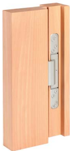
Tür 90° geöffnet: Durch den Bewegungsablauf wird die hintere Türkante geringfügig von der Zargenkante abgehoben.
